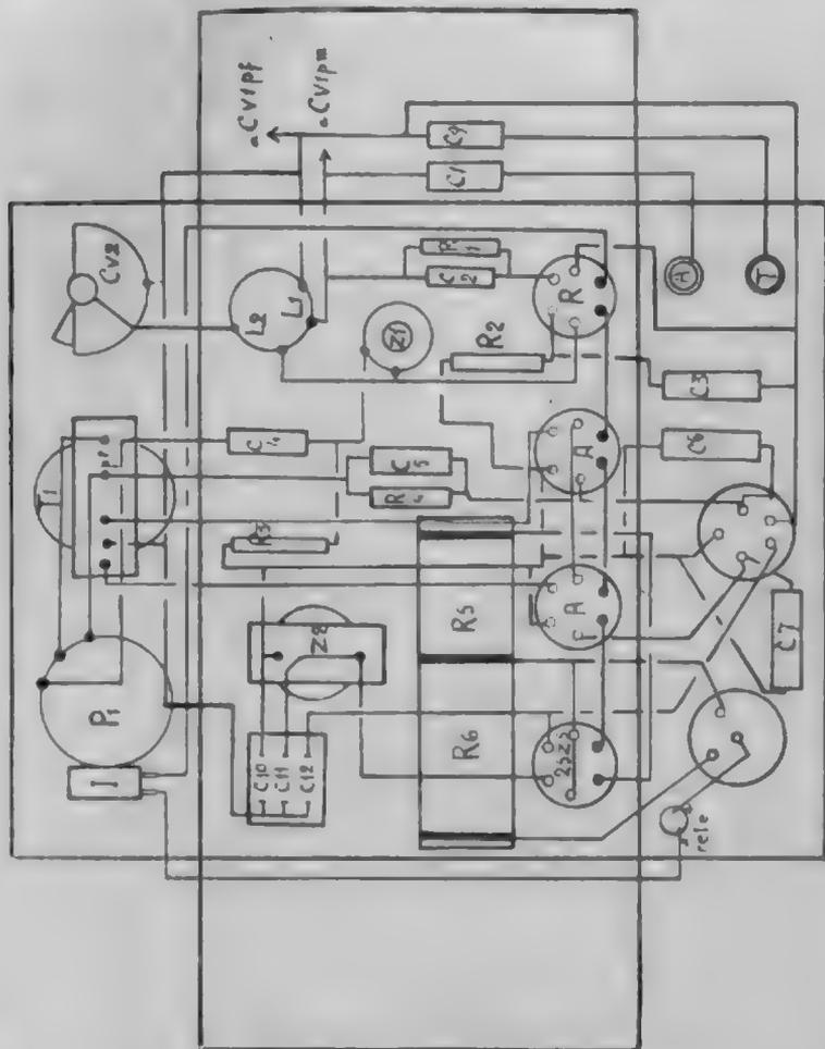
Fig. 80. - Piano di costruzione dell'apparecchio universale M 8.
