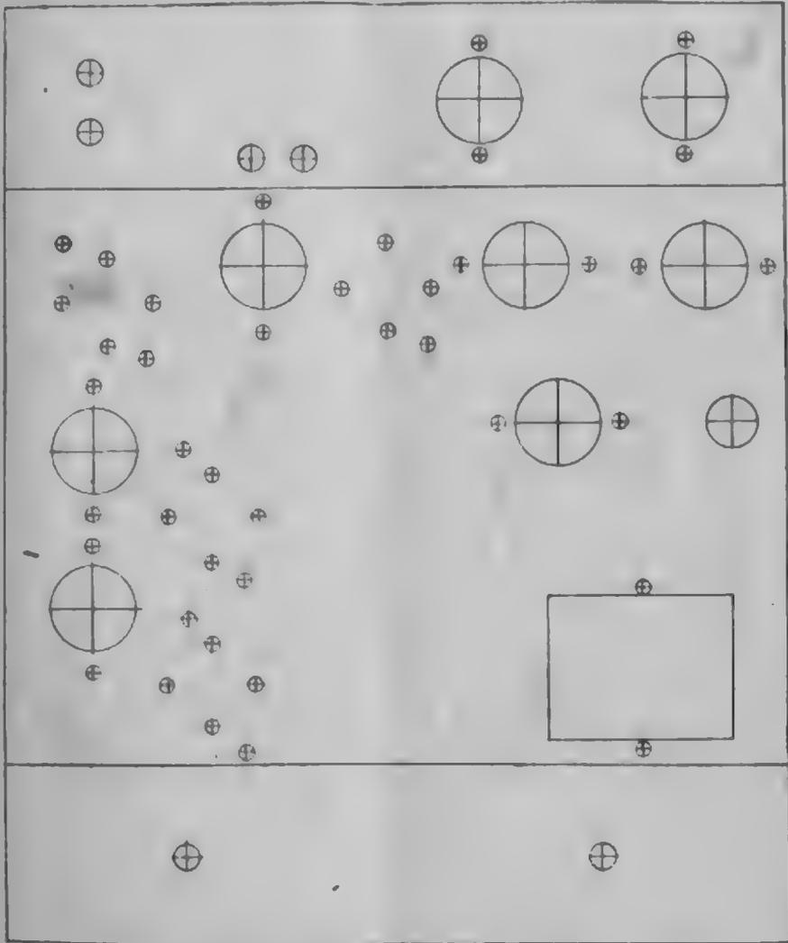
Fig. 4. - Piano di foratura di uno chassis.
