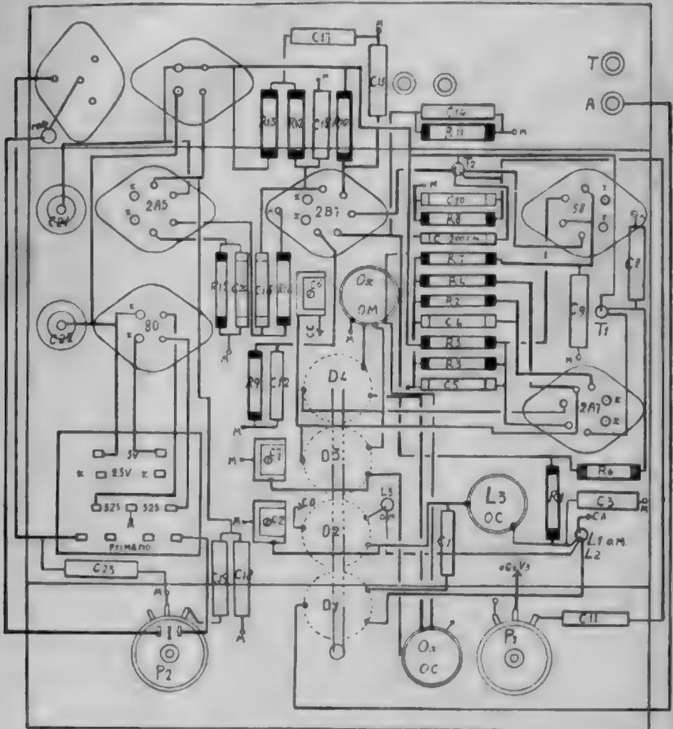
Fig. 58. - Piano di costruzione dell'apparecchio M 5.
