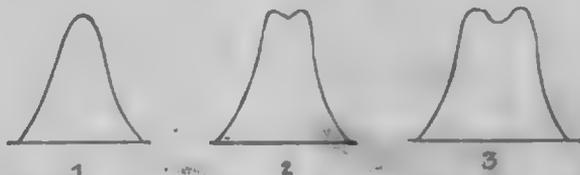
Fig. 23. - 1. Curva di sintonia di due circuiti ad accoppiamento largo. - 2. Se si stringe l'accoppiamento la curva di risonanza presenta due cuspidi. - 3. Con accoppiamento più stretto le due cuspidi si allontanano.
